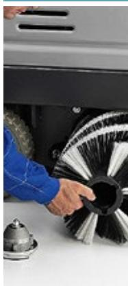
Эта система позволяет легко и быстро сменить центральную щетку без использования дополнительных инструментов. Оператору не требуется специальная техническая подготовка.
